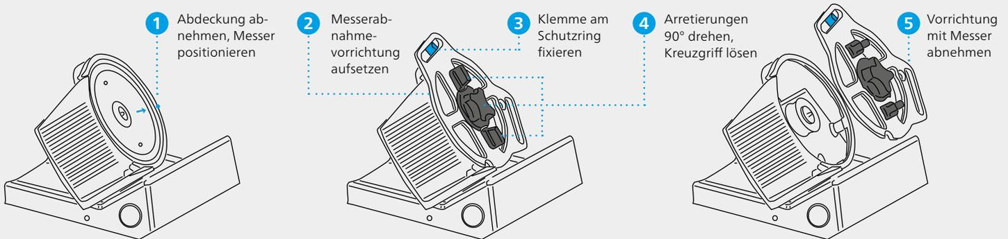
Maximale Arbeitssicherheit dank durchgehend berührungslosem Handling: Der Safe Blade Remover für neue GSP Schneidemaschinen verhindert jeglichen direkten Kontakt mit dem Messer bei Herausnehmen, Reinigen und Wiedereinsetzen.
