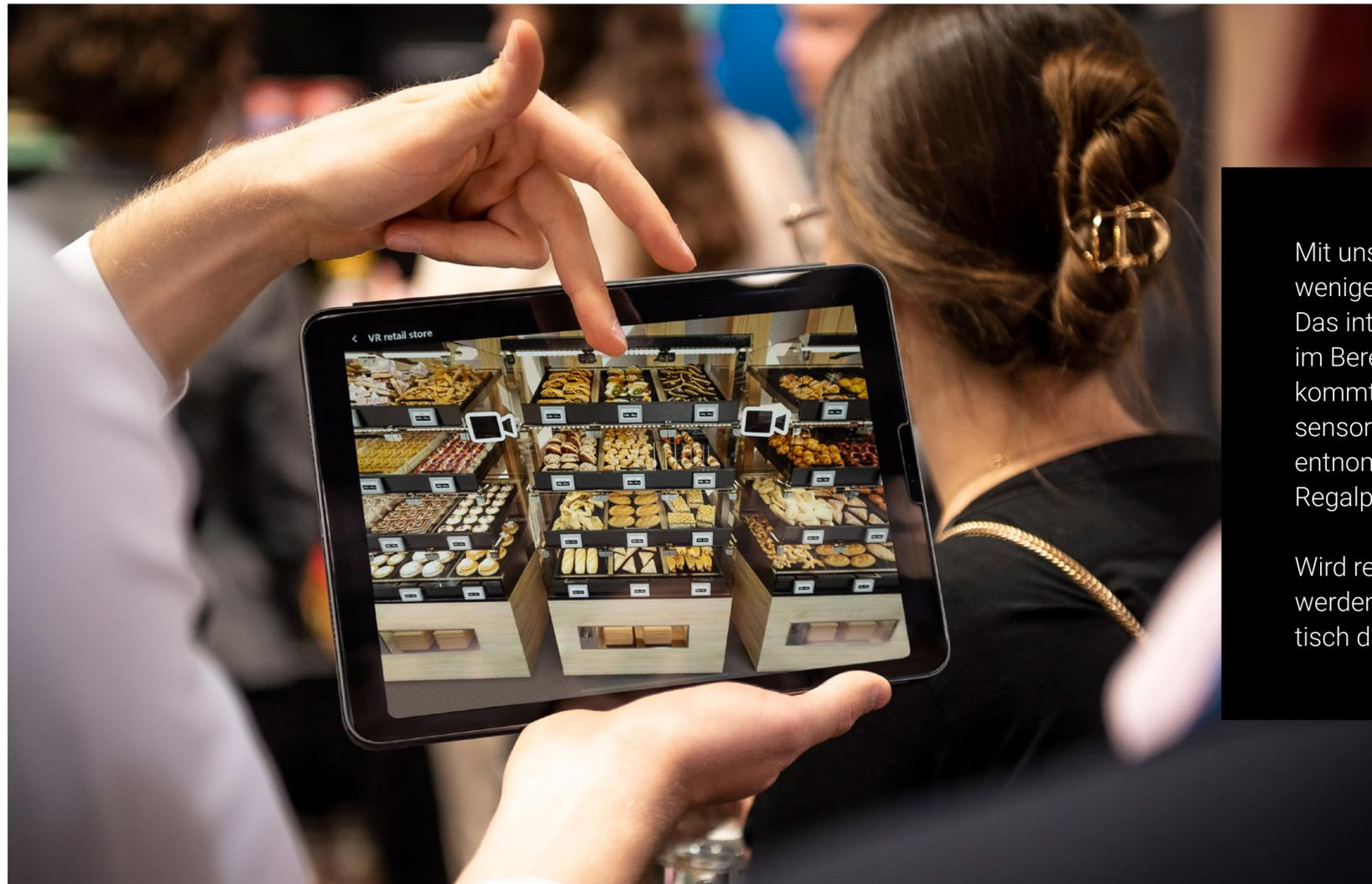
Mit unserem Smart Shelf sorgen wir für weniger Abfall durch Überproduktion. Das intelligente Bizerba Regal, das häufig im Bereich von Backwaren zum Einsatz kommt, erkennt durch seine Gewichtssensoren punktgenau, wenn ein Produkt entnommen wurde und dokumentiert diese Regalposition.
